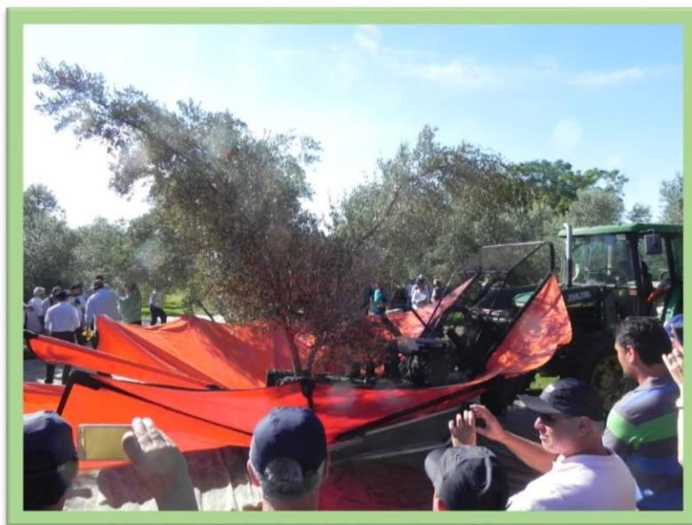
Figura 41 - Foto da máquina vibradora e coletora de azeitonas.
