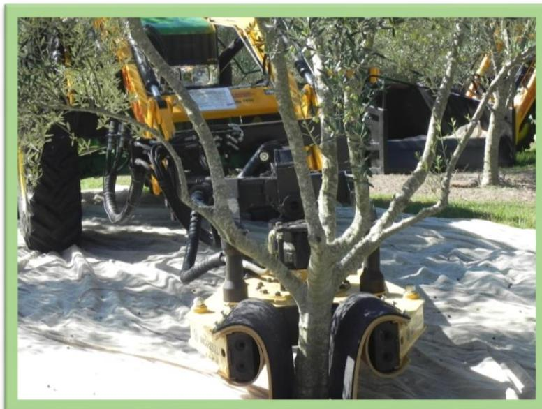
Figura 39 - Foto do trator para colheita com o sistema de vibração do tronco.
