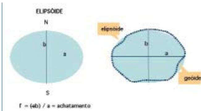
Localmente, a forma do elipsóide e a sua posição relativa ao geóide definem o que se chama de sistema geodésico (datum geodésico). No Brasil, adota-se o Sistema Geodésico Sul Americano (SAD 69), que tem os seguintes parâmetros:
