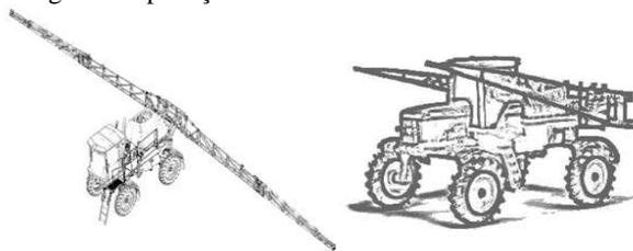
Pulverizador tracionado: implemento agrícola que, quando acoplado a um trator agrícola, pode realizar a operação de aplicar agrotóxicos.
