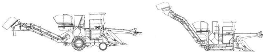
Colhedora de forragem ou forrageira autopropelida: equipamento agrícola automotriz apropriado para colheita e forragem de milho, sorgo, girassol e outros. Oferece corte preciso da planta, sendo capaz de colher ou recolher, triturar e recolher a cultura cortada em contentores ou veículos separados de transbordo.
