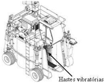
Colhedora de cana-de-açúcar: equipamento que permite a colheita de cana de modo uniforme gerando maior produtividade, por possuir sistema de corte de base capaz de cortar a cana-de-açúcar acompanhando o perfil do solo, reduzindo a quantidade de impurezas e palha no produto final. Possui um sistema de elevador que desloca a cana cortada até a unidade de transbordo.
